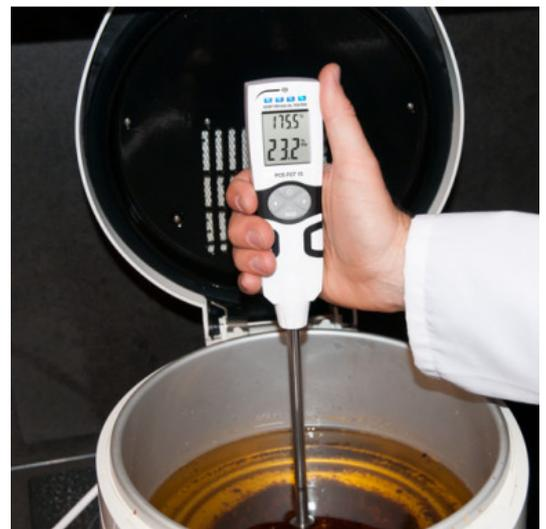
Nos équipes d'expert de la mesure ont sélectionné pour vous cet instrument de mesure à la fois précis, robuste et en provenance de la marque PCE, acteur reconnu de la mesure. **Le thermomètre pour friture PCE-FOT 10 est un appareil qui détermine la qualité des différents types d'huiles.** Les inspecteurs de l'action sanitaire utilisent avec succès ce thermomètre pour friture.
